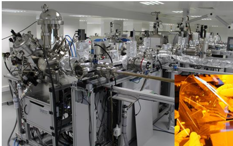
Figure 48 : Equipex ELORPrintTec . Ligne d'ultraviolette utilisée dans le dépôt et la caractérisation des films minces. Insert : électrode transparente obtenue par les technologies d'impression.
