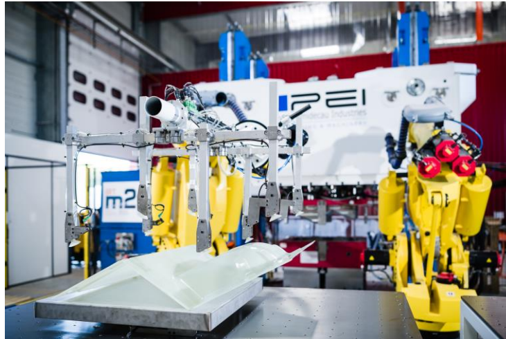
Figure 56 : Fast RTM : Développement des systèmes de préformage et d'injection pour des pièces de structure composite de grandes dimensions.
