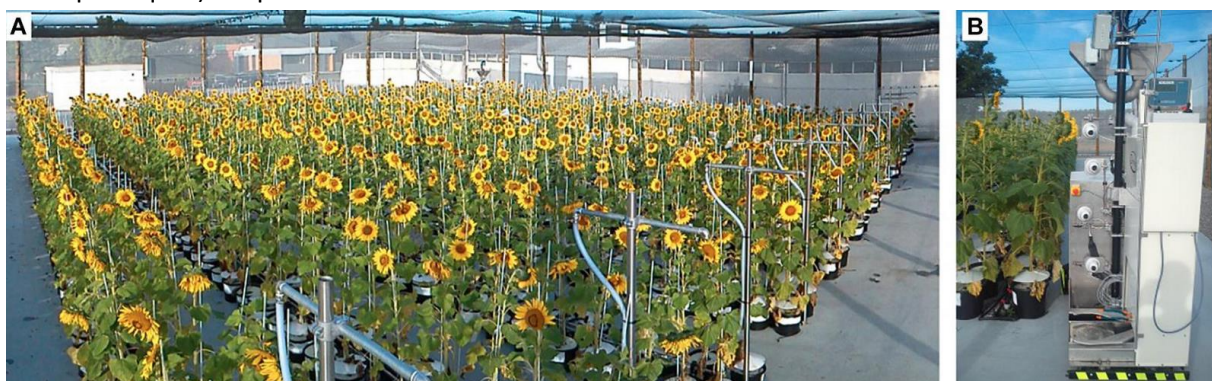
Heliaphen est une plateforme de 650 m 2 pouvant accueillir 1300 plantes (A) munie d'un robot capable de ramasser les pots, de les peser et de les arroser, et de phénotyper des plantes individuelles (B).
