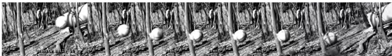
L'ailante résistant à l'impact expérimental d'une boule de granite de 56 kg à 50 km/h. Copyright : Irstea.
