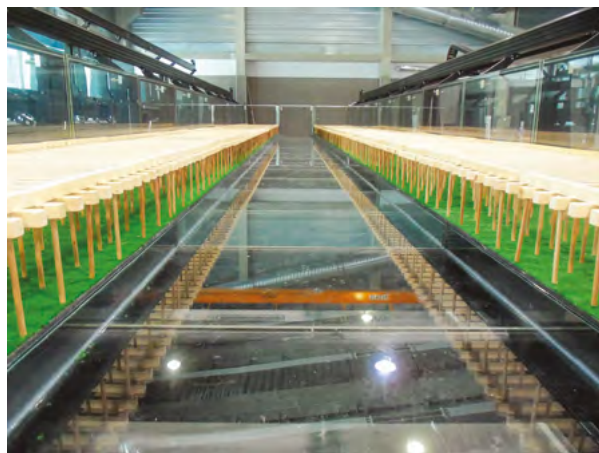
Étude en canal de laboratoire de l'influence de zones boisées (en lit majeur) sur les écoulements de crues extrêmes. Crédit photo : IRSTEA.
