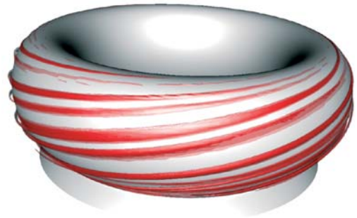
Simulation d'une instabilité magnétique au bord du plasma : des filaments de plasma sortent du plasma avec une vitesse de plusieurs km/s.
