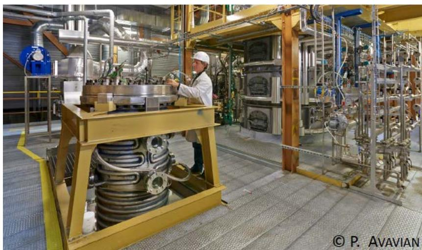
**Figure 8 :** Unités de gazéification et de torréfaction (arrière-plan) de GENEPI.
