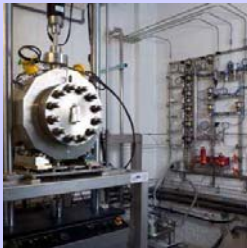
Détail du montage d'une éprouvette de type CT avec extensomètre COD
