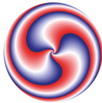
Carte du front de phase spatiale d'un faisceau harmonique produit sur miroir plasma par un faisceau laser à vortex de phase
