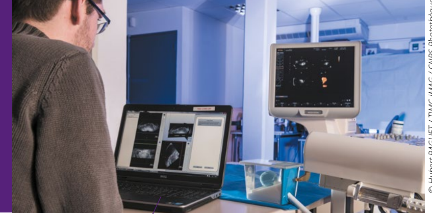
Robot guidé par l'imagerie ultrasonore 3D pour la curiethérapie du cancer de la prostate. Mise au point d'une version clinique
