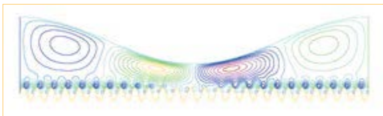
+ Profil de vitesse dans un écoulement à couche mince, à proximité d'une frontière rugueuse.
