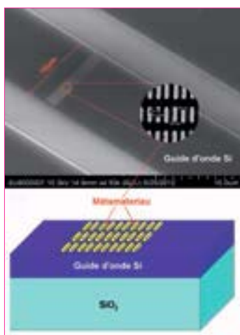
Représentation schématique (en bas) + et image MEB (en haut) d'un guide d'onde hybride en Silicium avec du métamatériau (agrandissement).
