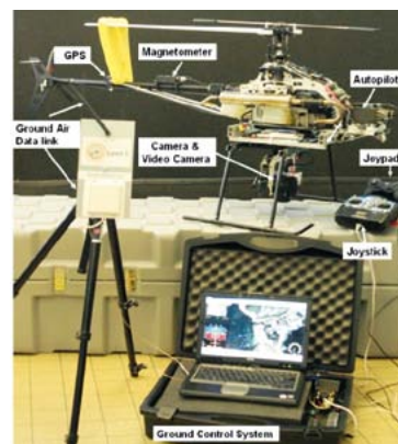
Le système DRELIO consiste en un hélicoptère autopiloté équipé d'un moteur thermique. Ce drone est équipé de capteurs de position et d'orientation qui permettent de traiter les photos par une chaîne de photogrammétrie dédiée.
