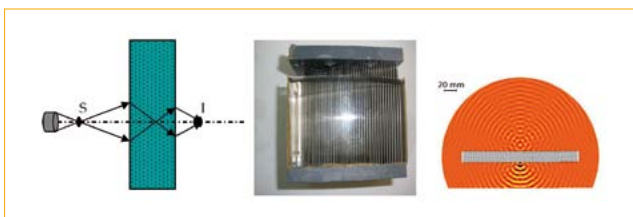
Dispositif à réfraction négative constitué de tiges d'acier dans une matrice époxy en vue de faire de la focalisation
