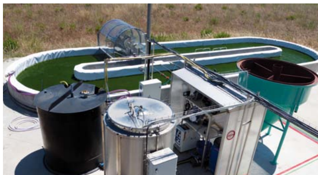
« L'algotron », procédé combinant culture de microalgues et digesteur anaérobie basé au LBE et conçu dans le cadre du projet Symbiose Crédit : Projet SYMBIOSE BIOE-2008 – B. Sialve
