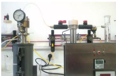
Mini-cedomètre couplé à un injecteur à pression contrôlée : appareil conçu au laboratoire pour infiltrer sous pression des solutions polluantes dans des argiles compactées afin de simuler le comportement des barrières argileuses des sites de stockage de déchets
