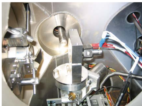
Cellule de mesure operando avec ses connexions électriques, installée pour des mesures d'XAS Crédit : Projet PULSSE
