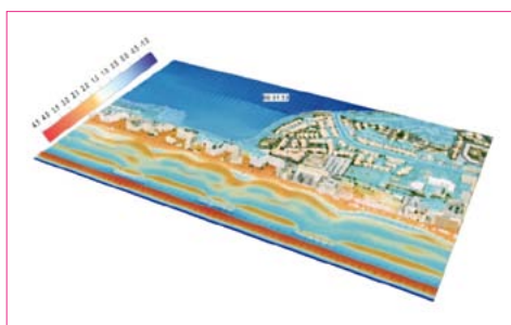
Modélisation d'une submersion exceptionnelle (hauteur de la surcote) liée à une tempête en 2010 sous l'hypothèse d'une élévation de la mer de 1m (conditions météorologiques de novembre 1982 en Méditerranée).
