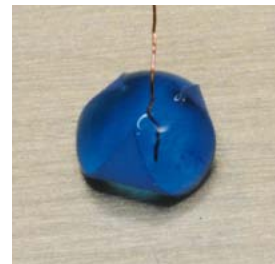
Origami capillaire piloté par un champ électrique : la structure initialement fermée s'ouvre lorsqu'une tension est appliquée sur l'électrode
