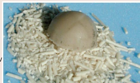
Demi-coque pour essai de mise en forme et compound PLA / fibre de verre
